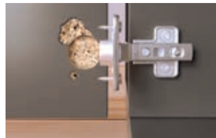
Reparatur ausgerissener Scharniere
