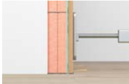
Abdichten von Türzargen
